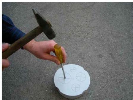
2. Scegliere i giunti filettati idonei, a seconda della quantità e dei diametri dei tubi/cavi, ed aprire i passaggi preforati
