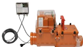
**Tipo 3:** Valvola antiriflusso per il montaggio orizzontale con una chiusura automatica azionata da energia esterna (elettrica, pneumatica o altro) e una d'emergenza, che è indipendente dalla chiusura automatica.
