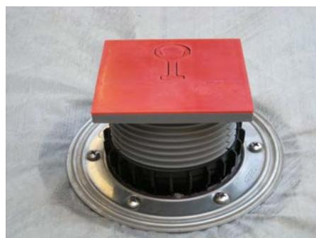
5. Fissare la guaina filtrante in feltro tra il set di impermeabilizzazione inox (HL83.0) e la prolunga (HL85N), inserire l'anello di drenaggio, adeguare il portagriglia con la protezione per il cantiere al livello finito delle mattonelle
