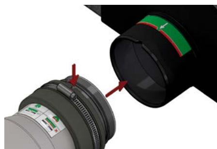
5. Collegare il piano con il tubo di allacciamento e fissare con una pinza
