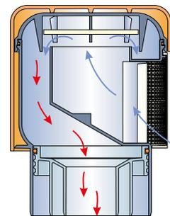
Con depressione nel sistema, l'aeratore si apre e l'aria che entra produce la compensazione di pressione.
