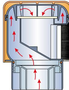
Con sovrappressione nel sistema, l'aeratore è perfettamente chiuso. Non possono uscire gas di canalizzazione.
