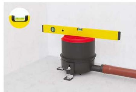
6. Connettere il corpo di scarico con la tubazione e regolare la pendenza con i piedini regolabili in dotazione.
