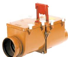
**Typ 2:** Nepovratni ventil sa duplom automatskom klapnom i jednim nužnim zatvaračem kod kojega nužni zatvarač može biti u kombinaciji sa jednim automatskim zatvaračem.
