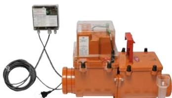
**Typ 3:** Automatski nepovratni ventil sa pogonom strane energije (električne, pneumatične ili druge) i jednim nužnim zatvaračem koji je neovisan od automatskog zatvarača.
