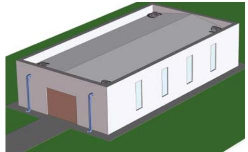
Slika 7: Ilustracija rješenja sekundarne odvodnje slivnika s priključenom vertikalom
