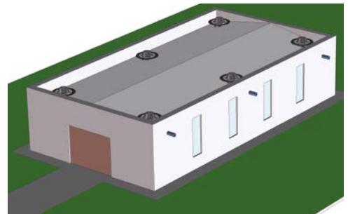
Slika 8: Ilustracija usvojenog rješenja sekundarne odvodnje slivnika s produžnim elementom
