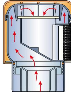
Kod nadtlaka u cijevnom odvodnom sistemu dozračni ventil sigurno brtvi od neugodnih mirisa. Plinovi iz kanalizacije ne mogu prodirjeti u prostoriju.
