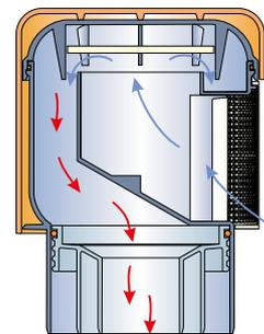
Kod podtlaka, u cijevnom sistemu se otvori ventil i protok zraka stvara izjednačenje pritiska.
