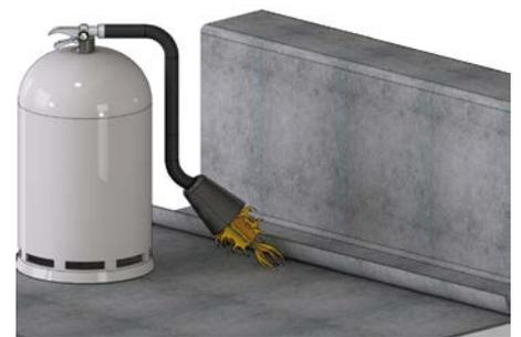
3. Erste Lage der vertikale Abdichtung gemäß Bild verlegen
