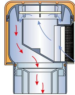
Drenaj sisteminde negatif basınç oluşması durumunda, havalandırma şapkası sistemin içerisine hava bırakır ve basıncı dengeler.
